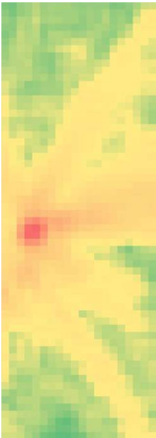
Рис. 3. Распределение колебаний при приклеивании одной УЗКС.
