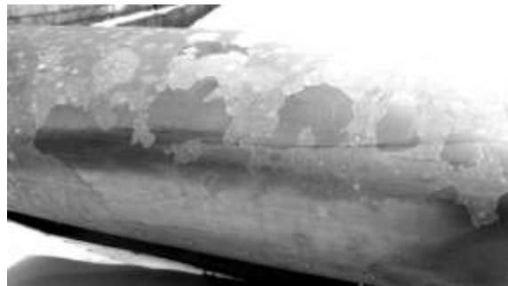
Рис. 10. Корка льда, разрушенная ультразвуковыми колебаниями
