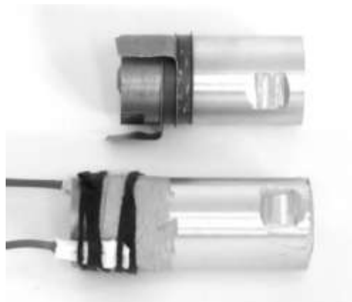
Рис. 2.1 Внешний вид пьезопреобразователей на рабочие частоты 30 кГц и 40 кГц
