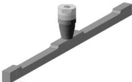
Рис. 5. Трехмерная модель УЗКС с распределителем колебаний
