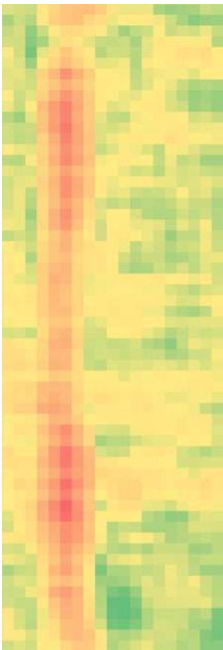
Рис. 7. Распределение колебаний на поверхности исследуемого объекта при приклеивании УЗКС с распределителем.
