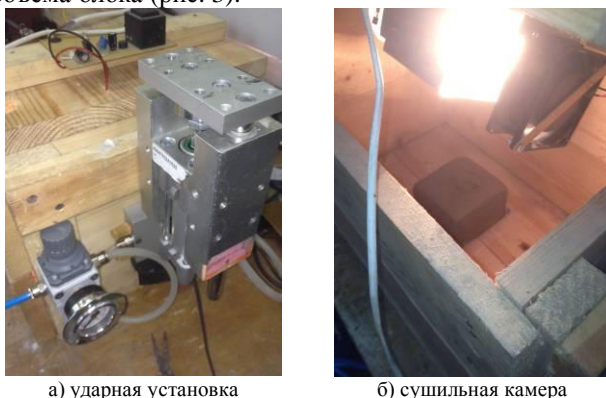
Рис. 3. Установка для получения образцов газобетона
