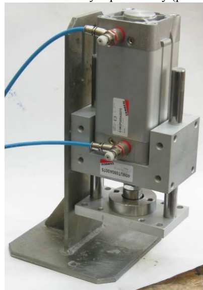
Рис. 4. Установка для испытания прочности на сжатие образцов газобетона
