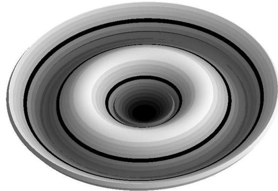
Рис. 2 – Третья мода колебаний дискового излучателя (4134,5 Гц)
