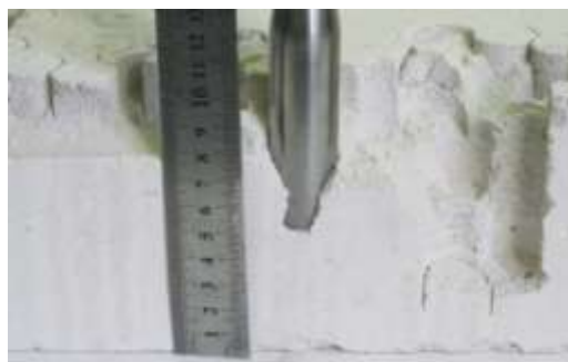
Рис. 6. Процесс сверление блока из пенобетона
