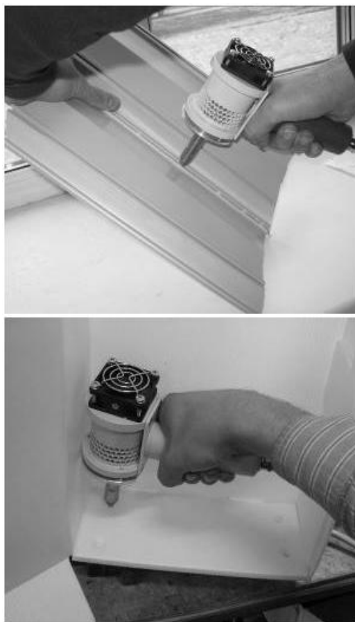
Рис. 2. Применение ручных сварочных инструментов для ультразвуковой сварки.
