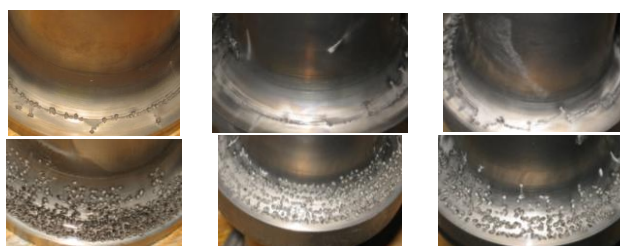
Рис.5. Неравномерный кавитационный износ модулей
