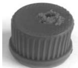
Рис. 2. Фото разрушенной крышки аккумулятора холода.
