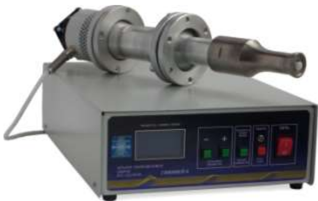
Рис.7. Разработанный аппарат для сварки крышек аккумулятора холода.
