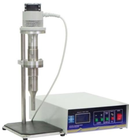
Рис. 2. Ультразвуковой аппарат для исследования кавитационной прочности материалов
