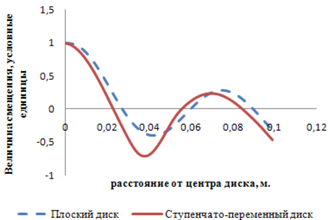
Рис. 2.- Форма колебаний плоского и ступенчато-переменного дисков.
