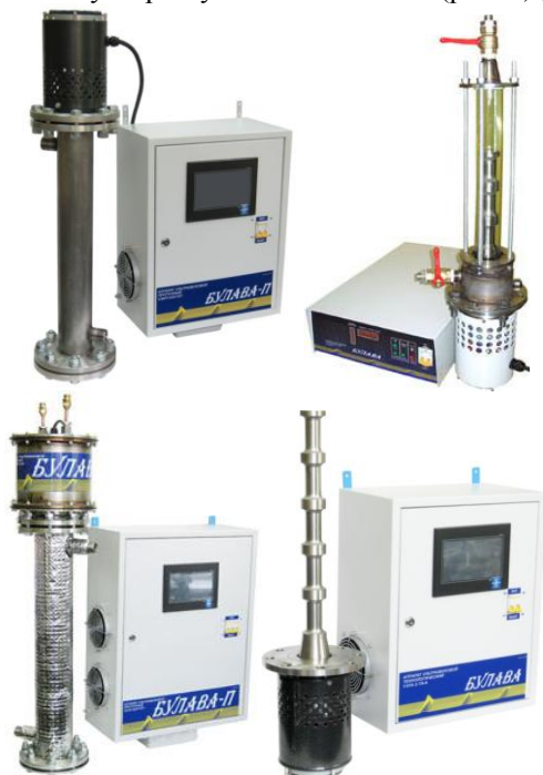
Рис. 1. Ультразвуковые технологические аппараты с многополуволновыми излучателями
