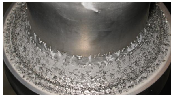
Рис. 8. Кавитационный износ поверхности ультразвукового инструмента
