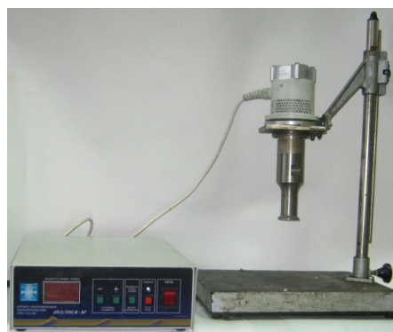
Рис. 3. Экспериментальный стенд для выявления зависимости объёма зон развитой кавитации от расстояния между излучателем и отражающей границей
