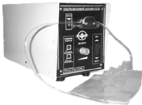
Рисунок 7 – Ультразвуковой запаиватель пластиковых контейнеров с компонентами крови, модель ЗУЗ-0,1/44-М1
