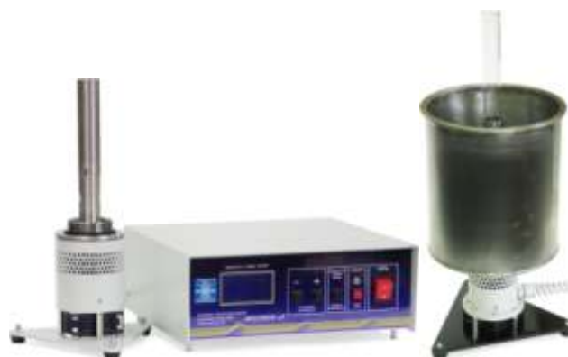
Рисунок 1 – Ультразвуковой аппарат для лабораторных исследований «Волна-Л» УЗТА-0,63/22-0Л
