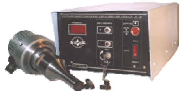
Установка ультразвуковой калибровки стеклопластикового несущего элемента для оптоволоконного кабеля.
