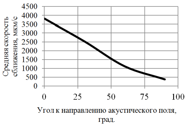
Рис. 2. Зависимость средней скорости сближения частиц от угла между линией центров частиц и волновым вектором акустического поля
