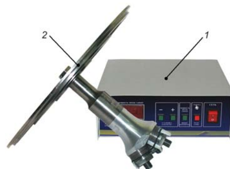
Рис. 2. Ультразвуковое оборудование для осаждения аэрозолей: 1 – ультразвуковой генератор; 2 – ультразвуковая колебательная система
