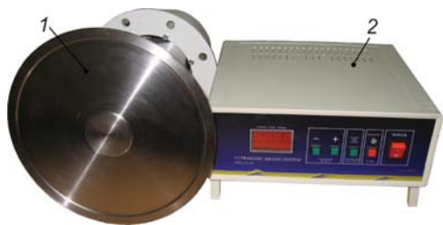
Рис. 7. Ультразвуковое оборудование для сушки различных материалов: 1 – ультразвуковая колебательная система; 2 – ультразвуковой генератор
