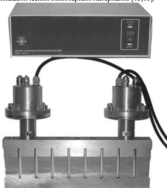
Рисунок 13 – Ультразвуковой аппарат для шовно-шаговой сварки термопластов.
