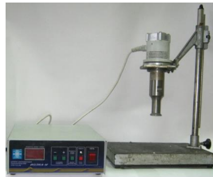
Рис. 3. Экспериментальный стенд для выявления зависимости объёма зон развитой кавитации от расстояния между излучателем и отражающей границей
