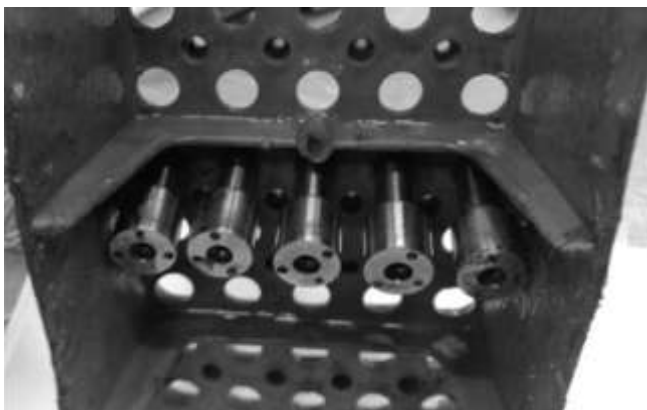
Рис. 8. Фото изделия после процесса очистки в каркасе.
