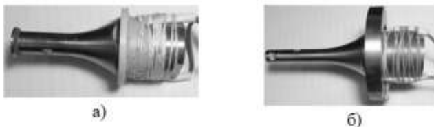
Рис. 2. Полуволновые УЗКС стержневого типа: а – с рабочим инструментом в виде пятака (тип 1); б – с торцевой излучающей поверхностью волновода (тип 2).
