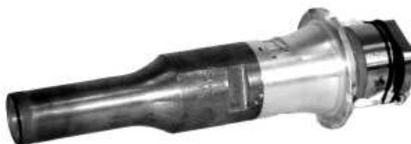
Рисунок 2 – Ультразвуковая колебательная система со сменными концентраторами ультразвуковых колебаний
