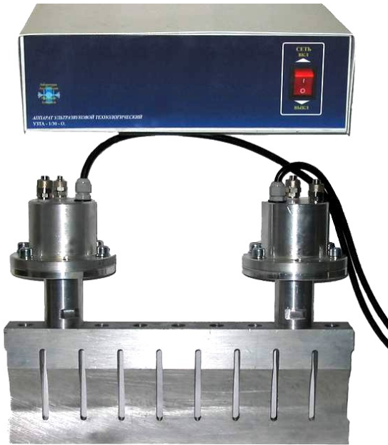
Фиг.5. Ультразвуковое технологическое оборудование для формирования сварных швов длиной 150 мм и 360 мм.
