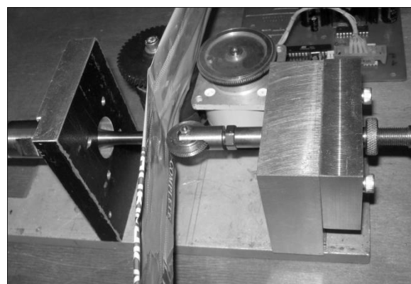
Рис. 2. Процесс непрерывной ультразвуковой сварки
