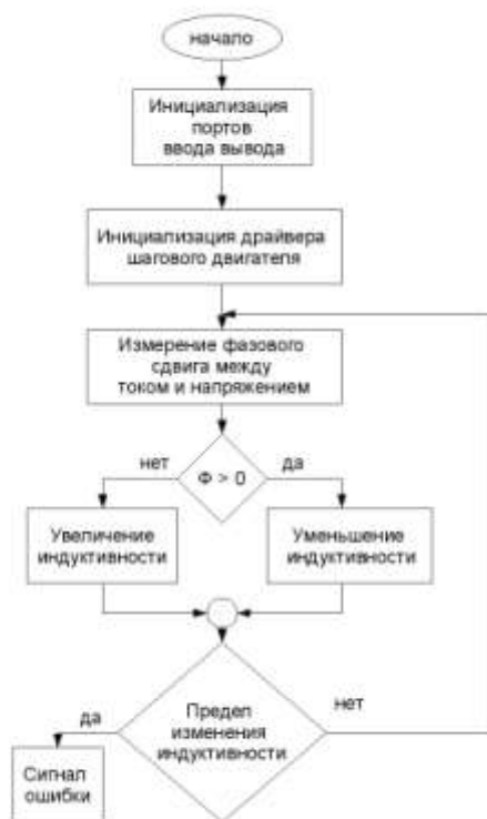
Рис 9. Блок-схема алгоритма управления индуктивностью согласующего звена.
