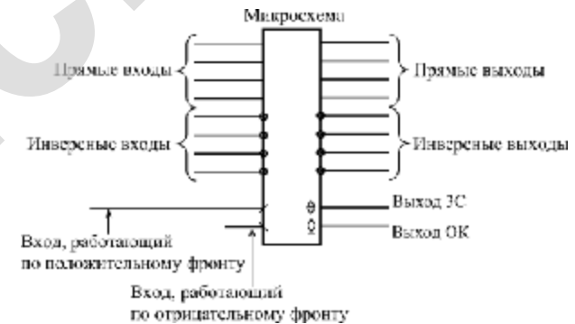
Рисунок 25.5 – Обозначение входов и выходов интегральной схемы
