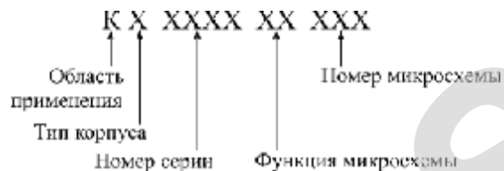
Рисунок 25.6 – Обозначения отечественных микросхем
