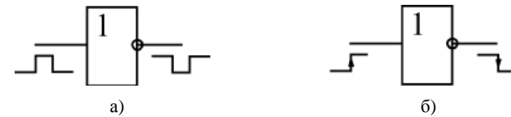
Рисунок 26.1 – Инверсия полярности сигнала (а) и инверсия полярности фронта сигнала (б)
