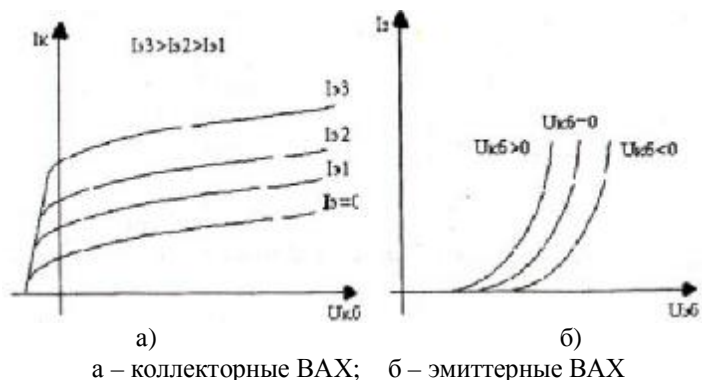
Рисунок 8.2 – ВАХ транзистора, включенного по схеме с общей базой
