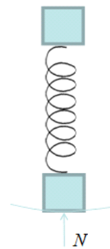
в) эквивалентное представление взаимодействия излучателя с грунтом (контакт присутствует)
