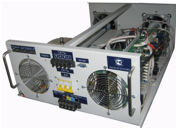
Рис. 2. Вариант исполнения электронного генератора УЗ аппарата «Булава».
