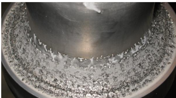
Рисунок 7 - Кавитационный износ поверхности ультразвукового инструмента
