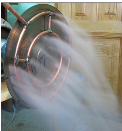
Рис. 5. Распыление жидкости УЗ дисковым излучателем с использованием системы подачи из двух медных трубок
