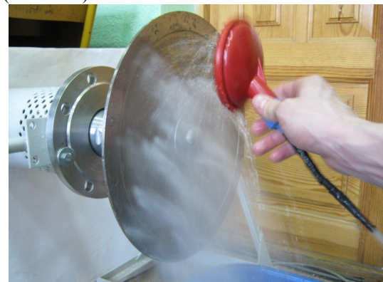
Рис. 3. Схема распыления УЗ дисковым излучателем с системой подачи в виде душевой насадки.
