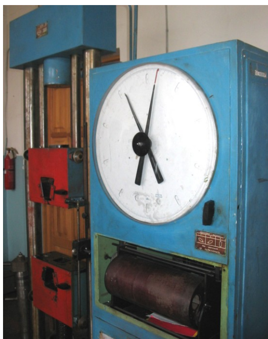
а) б) Рисунок 3 – Проведение испытаний на разрывной машине Р-10
