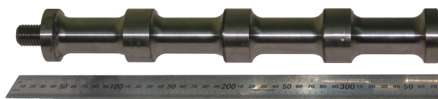
Рисунок 3 – Активный рабочий инструмент с увеличенной поверхностью излучения ультразвуковой энергии
