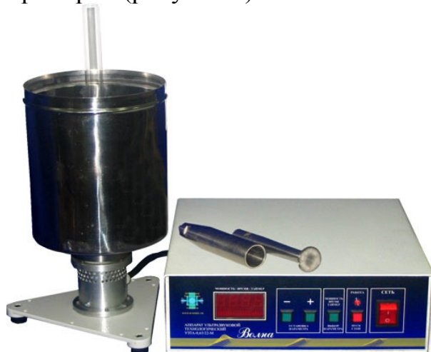
Рисунок 3 – Ультразвуковой химический реактор для обработки жидкостей в пробирках
