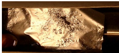
Fig 4. Металлическая фольга до (а) и после (б) кавитирующего воздействия
