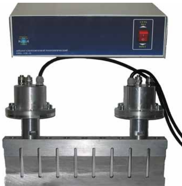
Рисунок 10 – Ультразвуковой аппарат “Рельсона” УЗТА 3/18-О для шовно-шаговой сварки.
