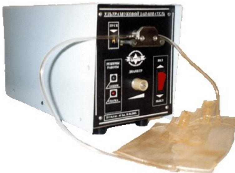
Рисунок 5 – Ультразвуковой запаиватель пластиковых контейнеров с компонентами крови
