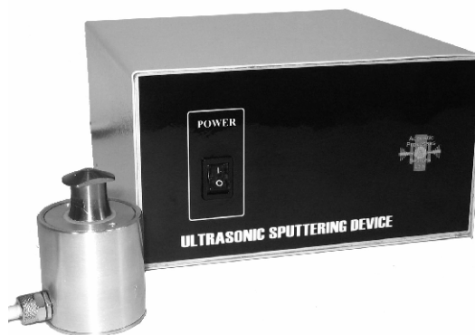
Рис. 8. Разработанный УЗ аппарат для распыления жидкостей
