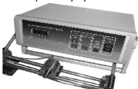
Рис. 3 Аппарат для ультразвукового распыления жидкости
