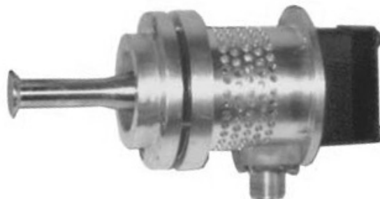
Рис.2. Фотография колебательной системы малогабаритного ультразвукового технологического аппарата
