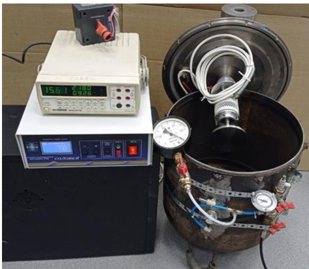
Рис. 5. Стенд для измерения акустической мощности Fig. 5. Stand for measuring acoustic power
