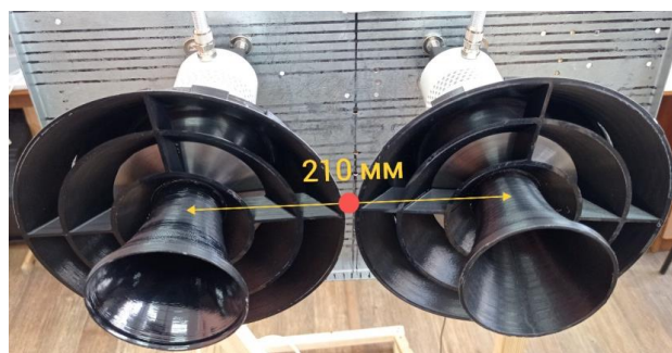
Рис. 13. Два ультразвуковых излучателя с отражателями и рупорами Fig. 13. Two ultrasonic emitters with reflectors and horns
