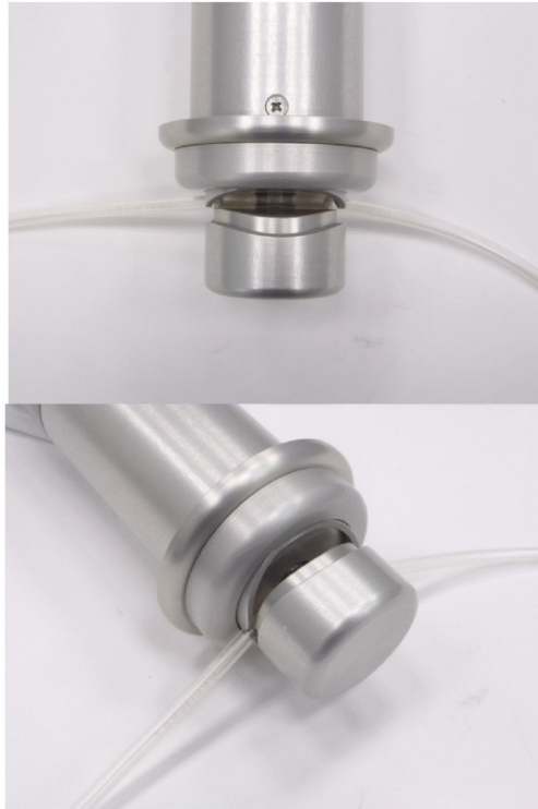
Фиг. 2. Размещение и фиксация магистрали в устройстве ультразвуковой герметизации медицинских магистралей
