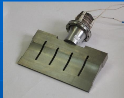
в) - двухполуволновая УЗКС для выполнения швов 220 мм;
