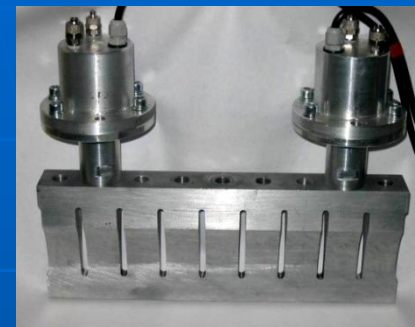
г) - двухполуволновая УЗКС для выполнения швов 360 мм;
