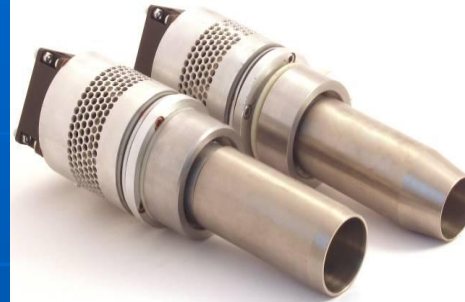
в) - двухполуволновая УЗКС для швов диаметром 60 мм;
