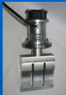
б) - двухполуволновая УЗКС для выполнения швов 150 мм;
