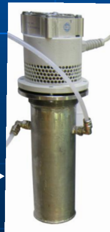
Модернизированный ультразвуковой излучатель оснащенный звукопроводящим объемом
