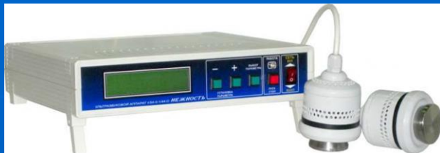
Ультразвуковой лабораторный аппарат «Нежность» для обработки жидких сред (частота колебаний 44 кГц, интенсивность воздействия до 4 \cdot 10^4 Вт/м 2 )
