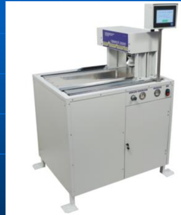
Устройство сварки по сложному контуру
