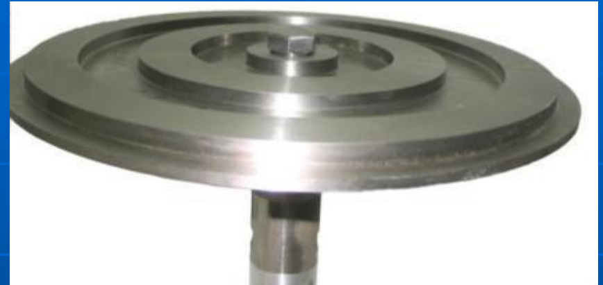
Излучатель с фазыравнивающими элементами
