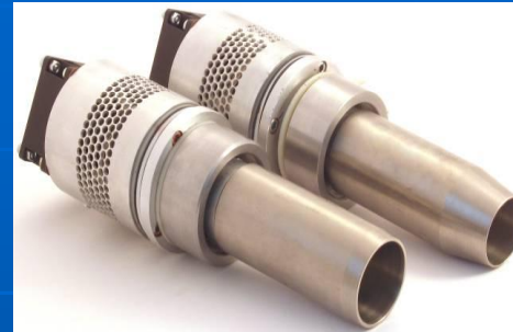
в) - двухполуволновая УЗКС для швов диаметром 60 мм;
