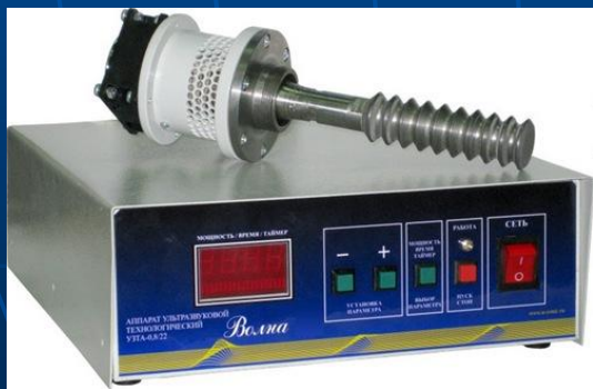
Ультразвуковой технологический аппарат для обработки жидких сред «Волна» (частота колебаний 22 кГц, интенсивность воздействия 3,5 \cdot 10^4 Вт/м 2 )
