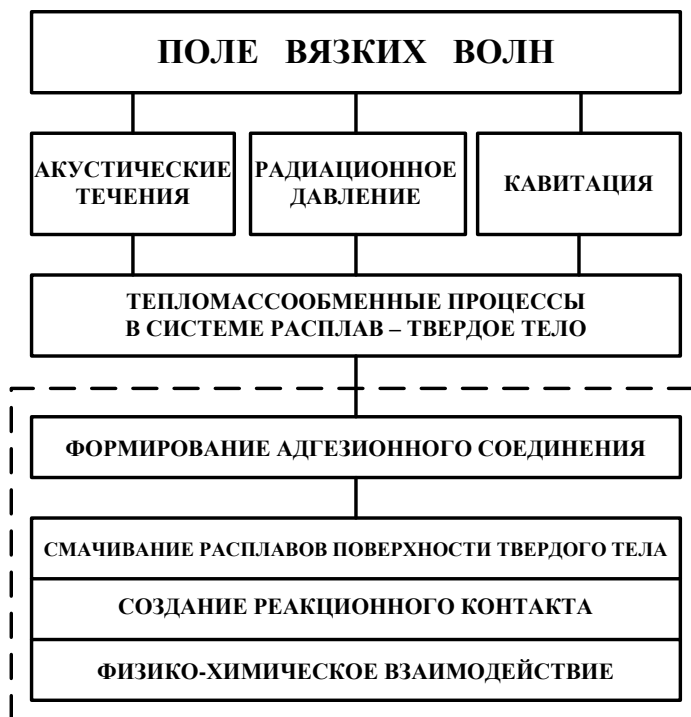
Рис. 2. Акустогидродинамические процессы при УЗМ по схеме тонкого слоя.
