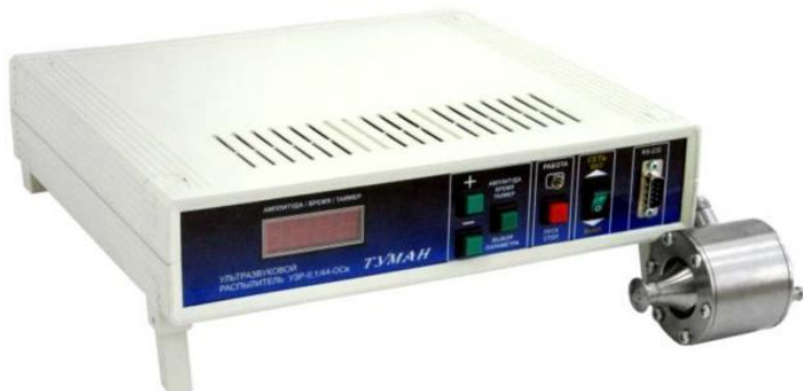
Рисунок А.3 – Ультразвуковой аппарат для распыления вязких жидкостей
