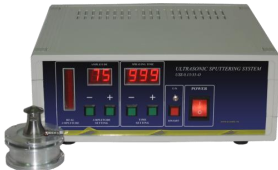
Рисунок А.5 – Аппарат для распыления вязких жидкостей с повышенной производительностью
