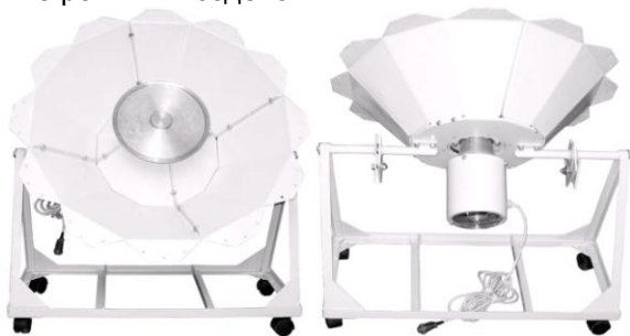
Рисунок 4 – Фотография ультразвуковой колебательной системы с дисковым излучателем
