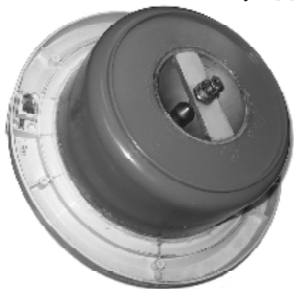
Рисунок 1. Внешний вид газоструйного излучателя рефлексорной схемы, смонтированного во фронтальную дверцу стиральной машины.
