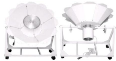
Рис. 3. Фотография ультразвуковой колебательной системы с дисковым излучателем
