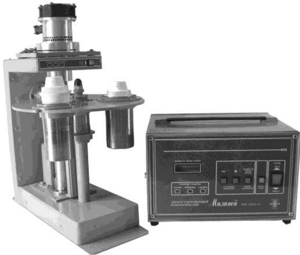
Рисунок 6 Установка сварки элементов картриджа.
