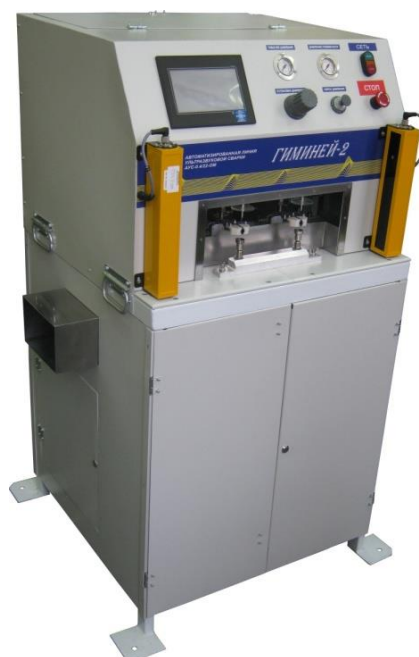
Рис. 6. Внешний вид автоматизированной линии карусельного типа
