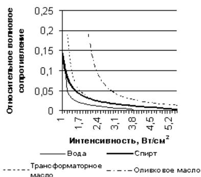
Рисунок 1 – Зависимость относительного волнового сопротивления от интенсивности воздействия для маловязких жидкостей: воды, спирта, трансформаторного масла и оливкового масла
